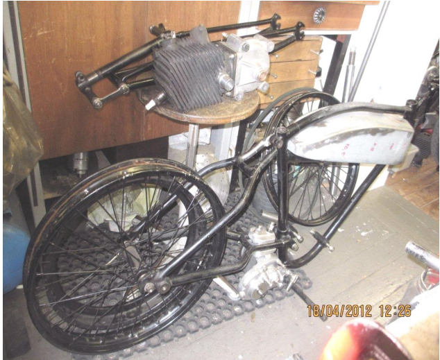
Onderhanden werk: Magnat Debon tweetakt uit 1924
